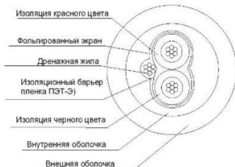
Рисунок 1. Поперечное сечение кабеля КММПЭВ 2x0,35 (Gamma-4CBL1041)
